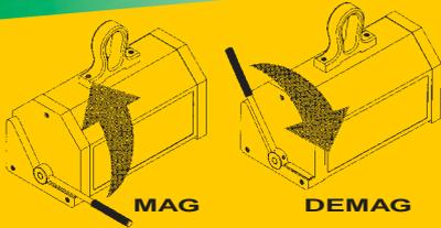
Con la simple rotación de la palanca se activa o desactiva el elevador. Un dispositivo de seguridad bloquea la palanca en la fase MAG, impidiendo cualquier posible desactivación accidental.
