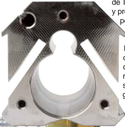
De bloques de acero, excavados del lleno, nacen tanto el "cuerpo" como el "rotor", con la utilización de modernas máquinas CNC y sistemas FMS, en grado de garantizar producciones en grandes series y el mantenimiento de un elevado standard de calidad en el mecanizado.
