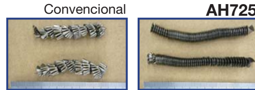
La forma de la viruta es plana y suave demuestra un estable mecanizado de la superficie (acero inoxidable)
